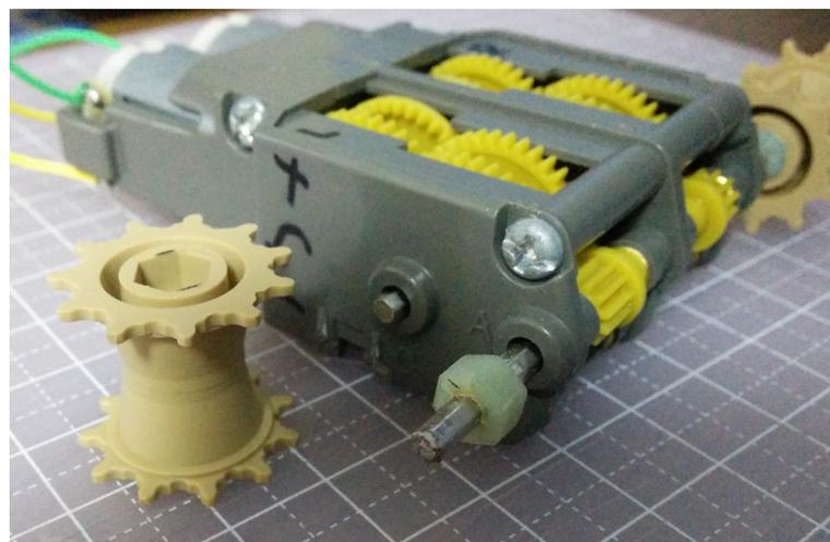
図 21 切断したシャフトと起動輪。
