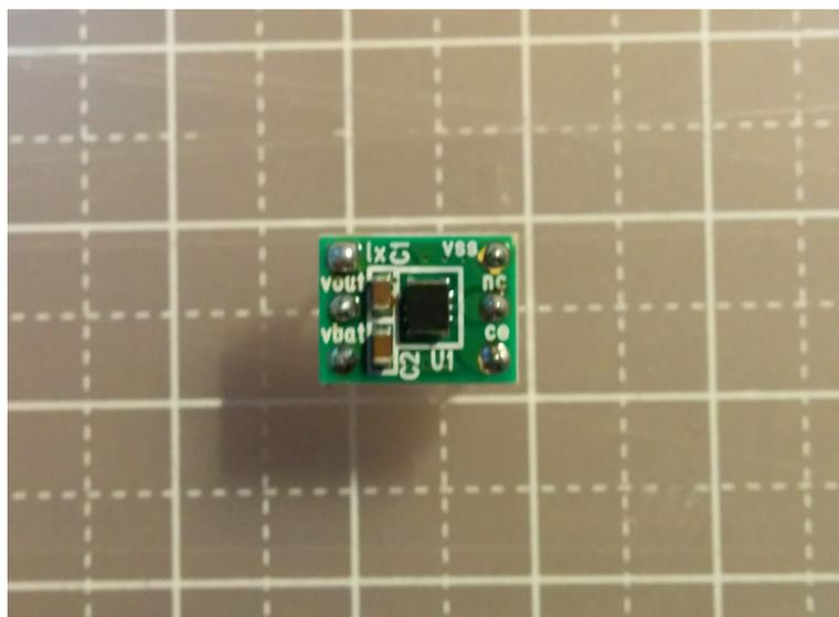
図7 昇圧型DC-DCコンバータ。
