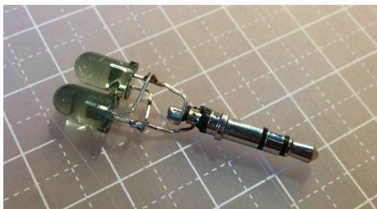
図5 イヤホンジャックに赤外線 LED を挿すことで赤外線の信号を送ることができる。
