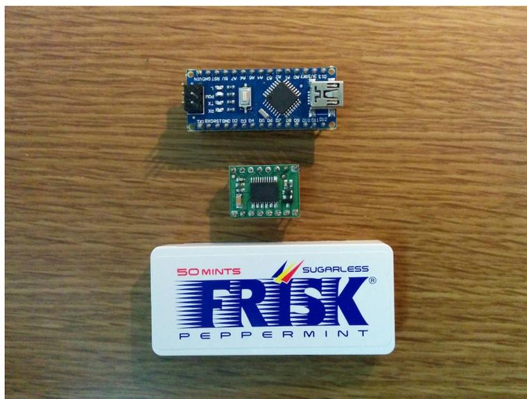
図4 マイコン Arduino Nano とモータードライバ TB6612FNG。
